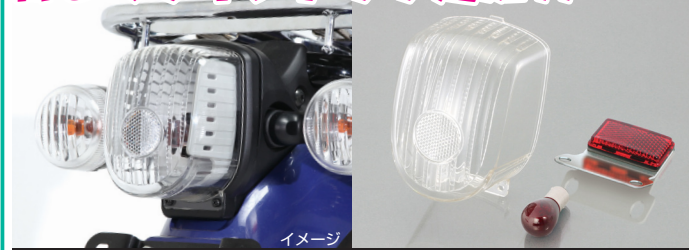
イメージ ノーマルテールレンズとバルブの交換で、簡単クリアタイプにチェンジ。
